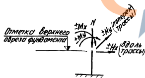
Схема нагрузок на фундамент
